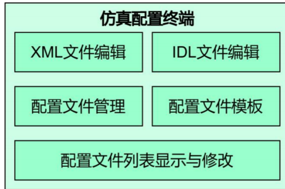
图 7 仿真配置终端结构设计
