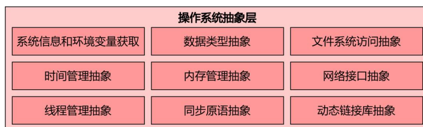
图 13 操作系统抽象层结构图
