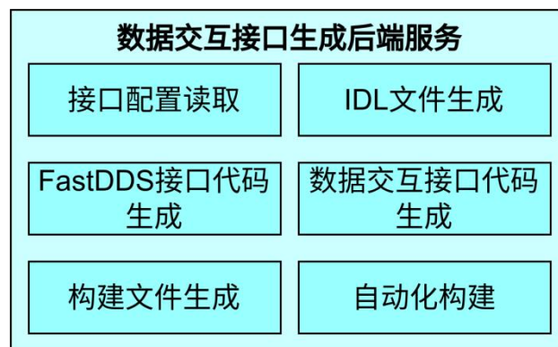
图 16 数据交互接口生成后端服务结构图
