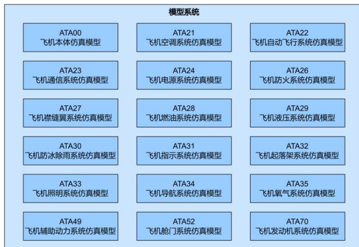
图 22 模型系统中模型组成
