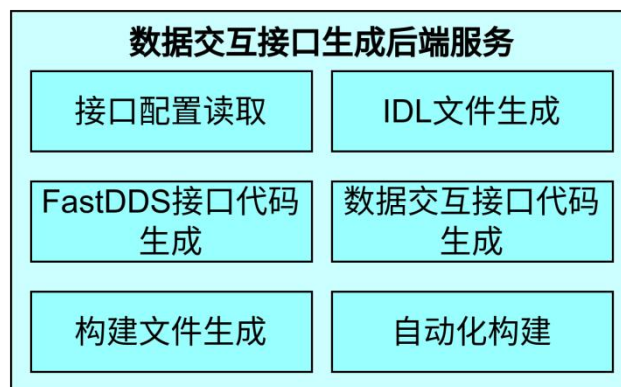
图 16 数据交互接口生成后端服务结构图
