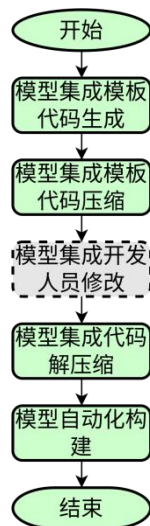
图 21 模型集成后端服务工作流程
