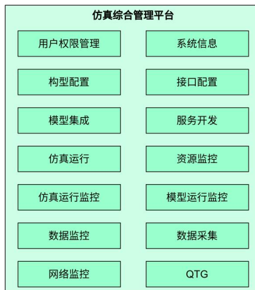
图 9 仿真综合管理平台结构设计
