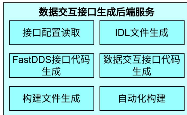
图 16 数据交互接口生成后端服务结构图
